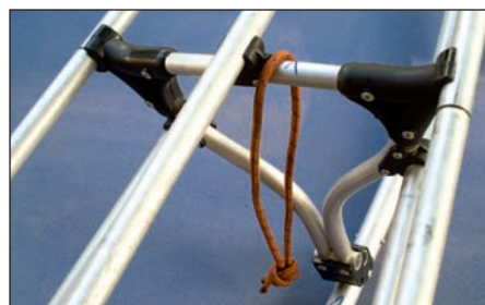
Der entscheidende Dreh beim Aufbau ist das Zusammenfügen der drehbaren Verbindungsköpfe (oben).
